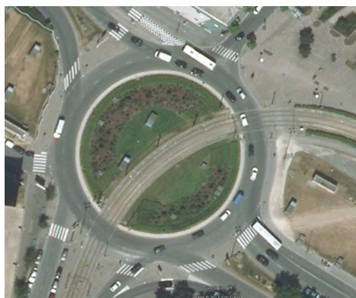
Figure 1 : Exemple de giratoire à 2 voies à l'anneau avec entrée à 2 voies + 1 voie bus et sorties bus en site propre sans déflexion (Bobigny, Seine-Saint-Denis)
