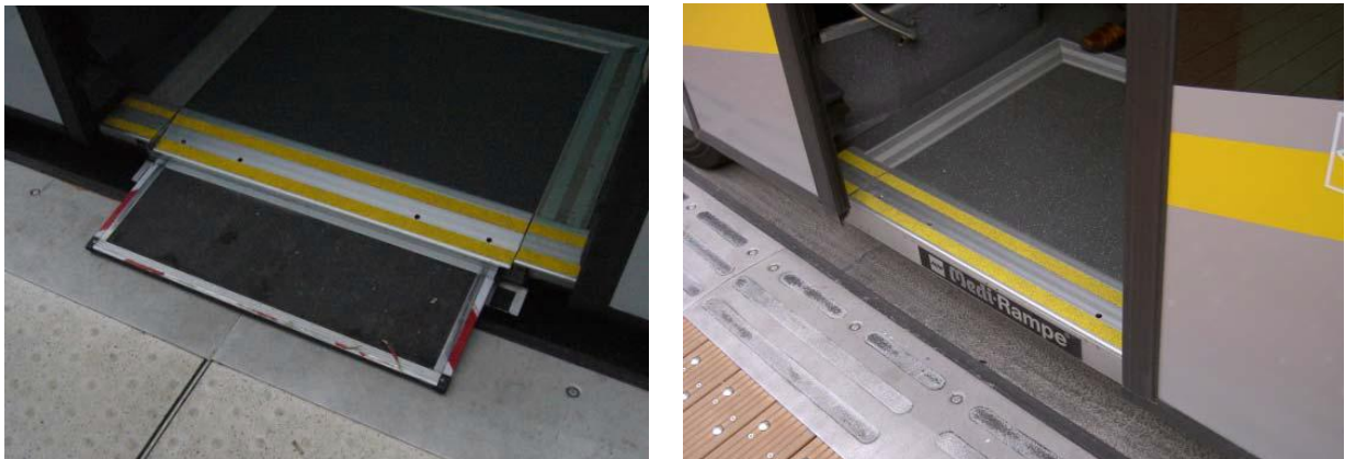
Figure 68 : Vue d’une rampe intégrée de type mini-palette ouverte et fermée (Exemple du Busway de Nantes)
